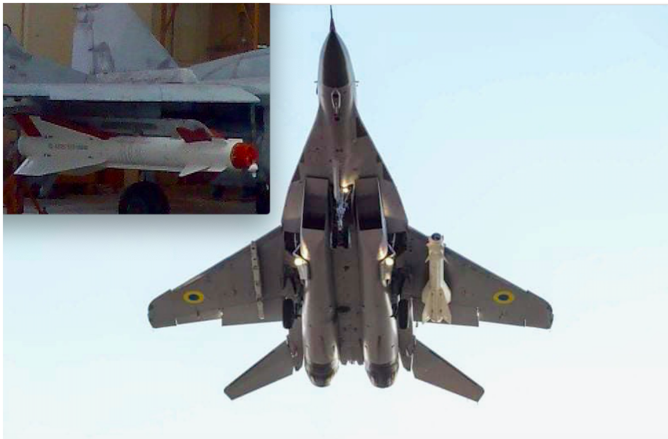
Samolot MiG-29MU2 podczas lotu z pociskiem Ch-29T oraz o rok starsze zdjęcie z prób naziemnych. Fot. mil.gov.ua
