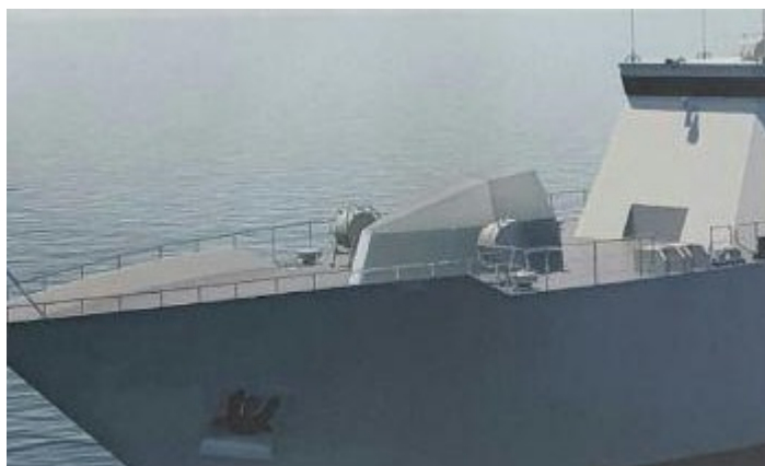
Wersja morska modułu artyleryjskiego AU-220M z zamkniętymi pokrywami zewnętrznymi. Fot. OA „Centralny Instytut Badawczo – Rozwojowy „Buriewiestnik””
