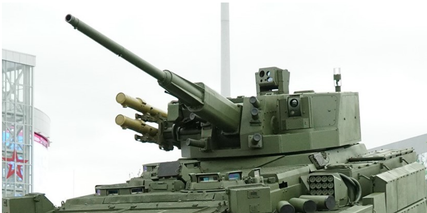
Wersja lądowa modułu artyleryjskiego AU-220M. Fot. OA „Centralny Instytut Badawczo – Rozwojowy „Buriewiestnik”
