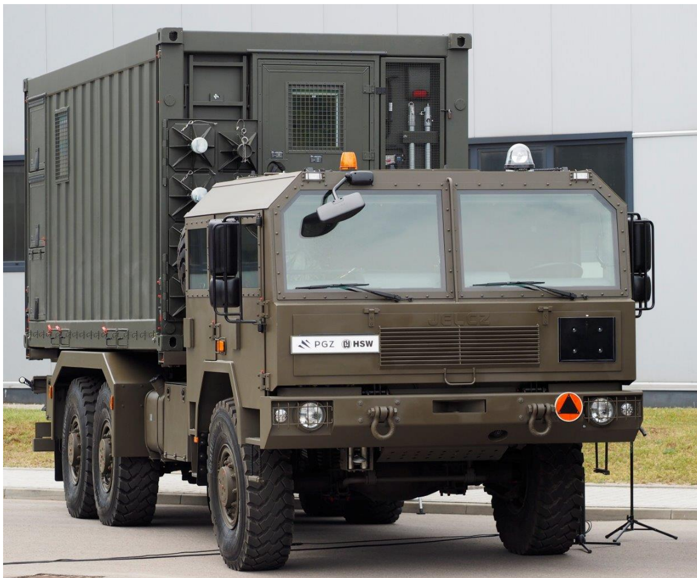
Artyleryjski Wóz Remontu Uzbrojenia AWRU korzysta z podwozia samochodu ciężarowego Jelcz P662D.35 z czteroosobową opancerzoną kabiną Jelcz 144, jest wyposażony w kontener z niezbędnym sprzętem, pozwalającym na wykonywanie w warunkach polowych diagnostyki oraz napraw sprzętu wojskowego. Fot. Jerzy Reszczyński/Defence24.pl
