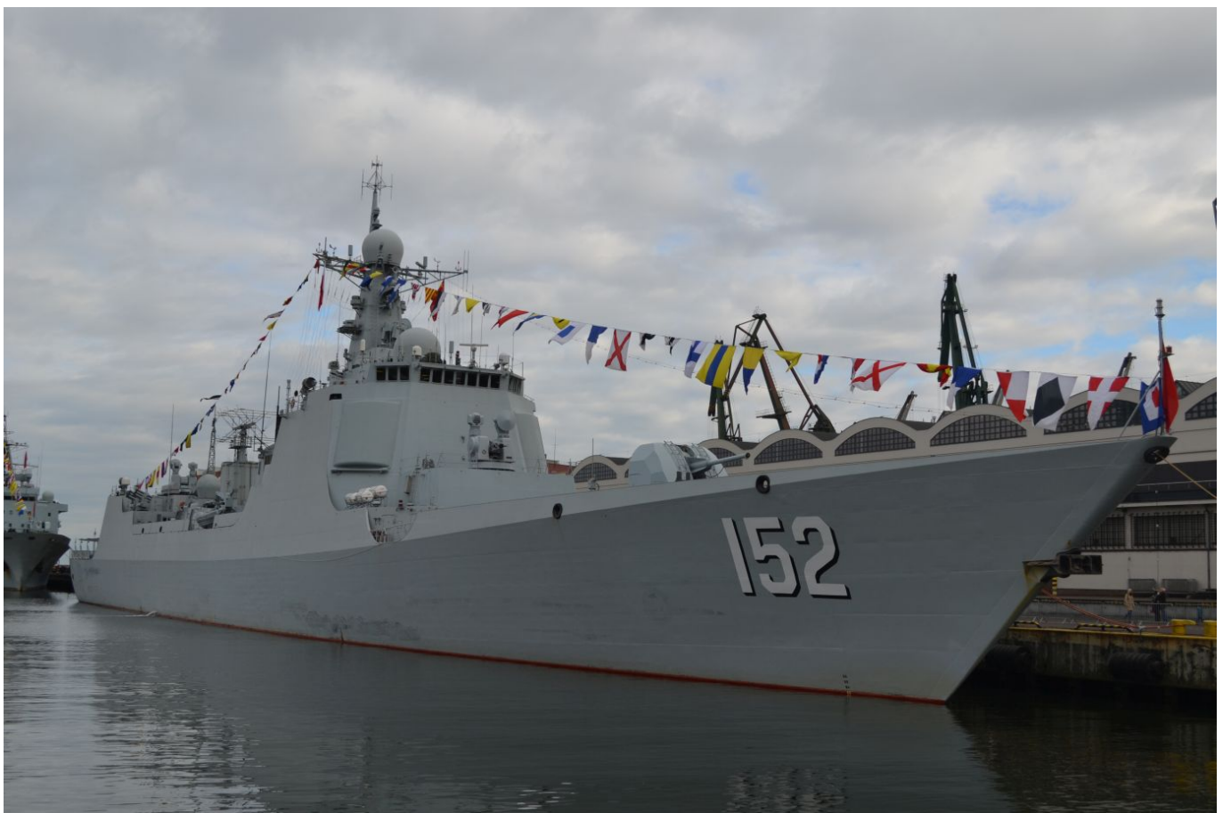
Chiński niszczyciel przeciwlotniczy „Jinan” typu 052C z radarem wysokich częstotliwości typu 346 z czterema antenami wkomponowanymi w nadbudówkach i z widocznym na śródokręciu systemem antenowym Yagi radaru bardzo niskich częstotliwości typu 517HA. Fot. M.Dura
