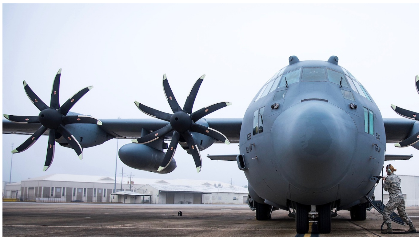
Nowe silniki Rolls-Royce T-56 Serii 3.5 i ośmiopłatowe śmigła NP2000 to wyższe osiągi i mniejsze zużycie paliwa. Fot. Eglin AFB
