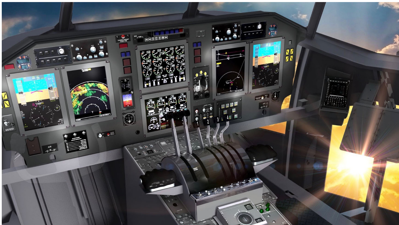
Jeden z projektów glass cockpitu C-130H opracowany przez L3 Harris w kooperacji z Rockwell Collins. Fot. Rockwell Collins
