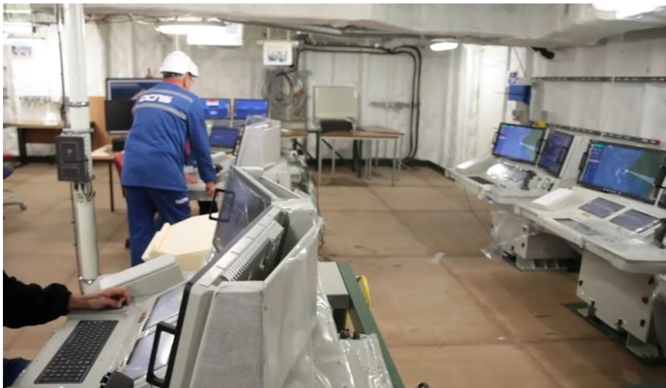
Bojowe Centrum Informacyjne w dolnej części modułu mogło zostać sprawdzone jeszcze przed zamontowaniem PSIM na okręcie - fot. DCNS
