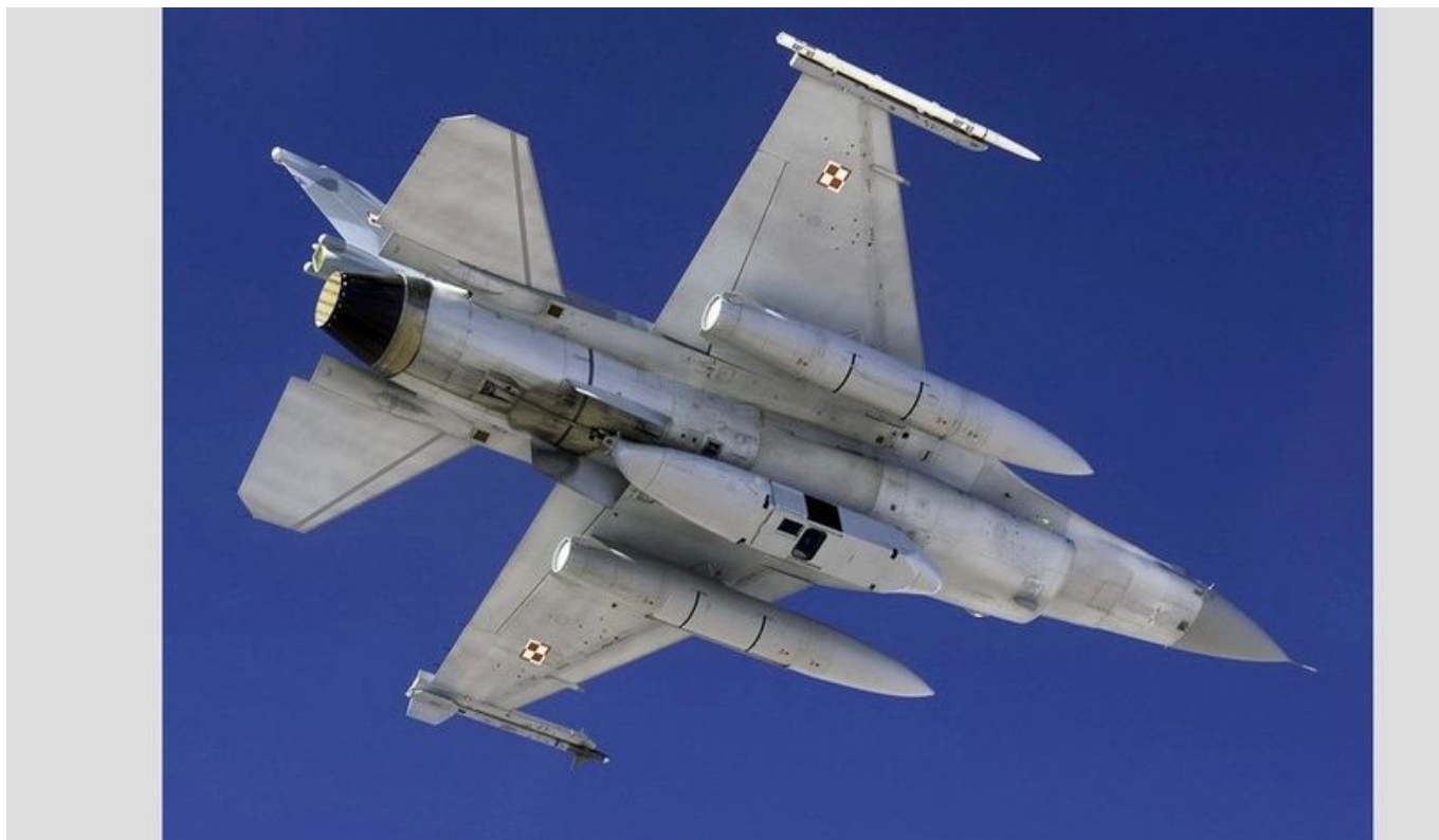
Polski F-16 z zasobnikiem DB-110 podczas testów w USA - fot. Lockheed Martin Tactical Aircraft Systems
