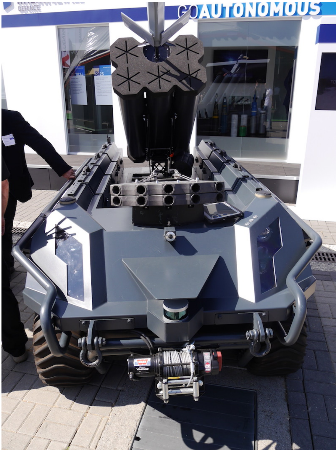
Robot Mission Master z wyrzutniami amunicji krążącej Warmate i widocznym na pierwszym planie systemem samoosłony Rosy. Fot. Mateusz Zielonka/Defence24.pl
