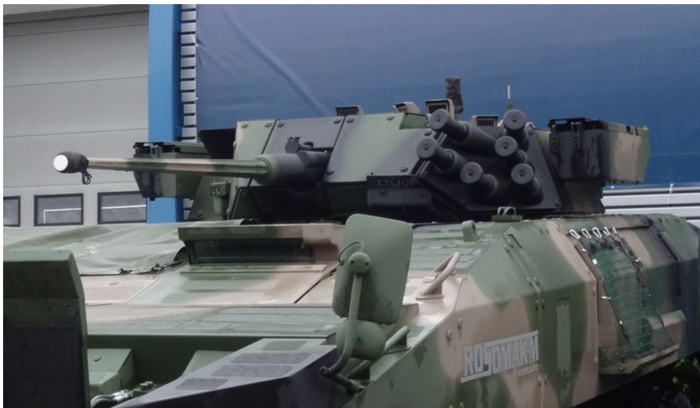
Wieża KTO Rosomak-M ze zintegrowanymi wyrzutniami ppk Spike - fot. J.Sabak
