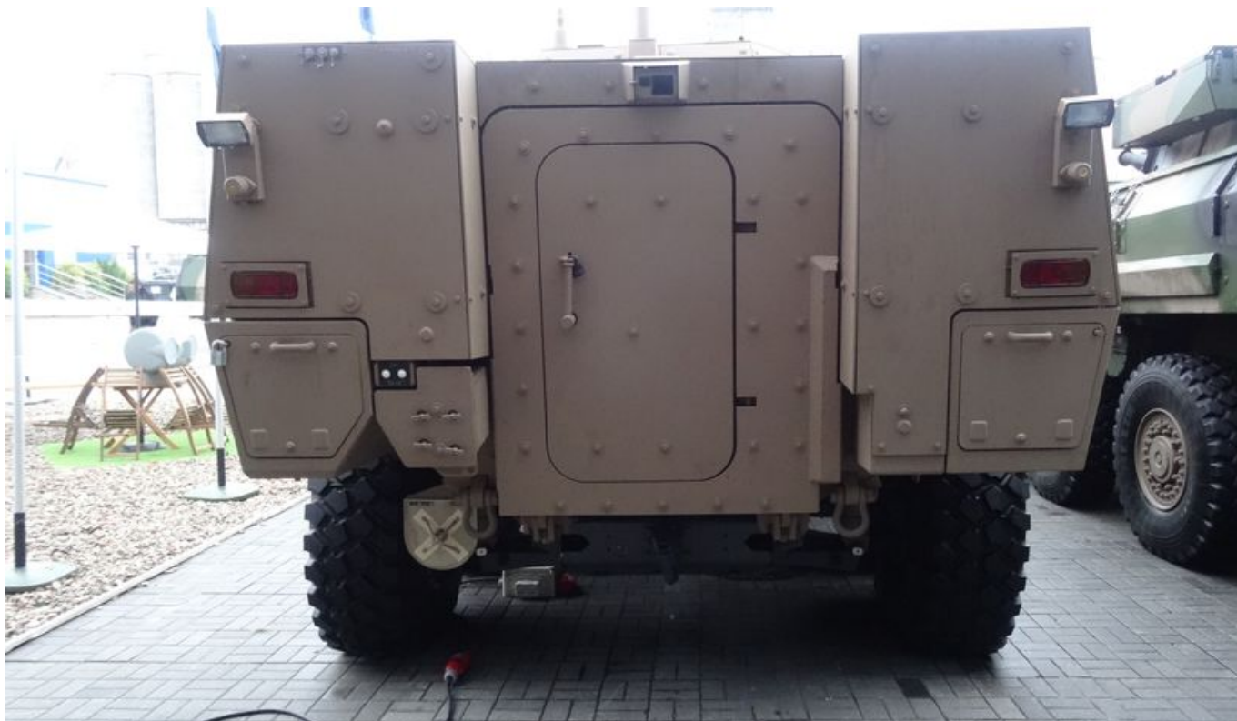
Tylna rampa z drzwiami pojazdu Rosomak XP - fot. J.Sabak
