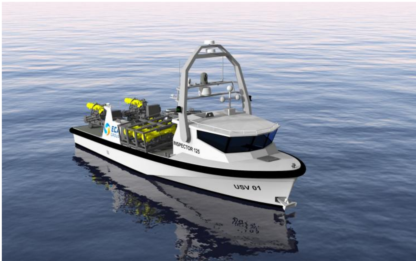
Zdalnie sterowany, bezałogowy pojazd nawodny INSPECTOR125 ma z założenia służyć m.in. do opuszczania i podnoszenia z wody bezałogowych pojazdów podwodnych. Fot. ECA Group
