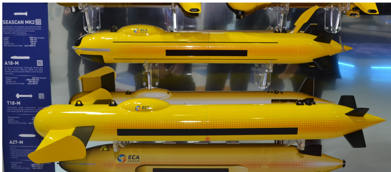
Rodzina bezzałogowych pojazdów podwodnych firmy ECA Group. Od góry dron A18-M, na dole sonar holowany T18. Fot. M.Dura
