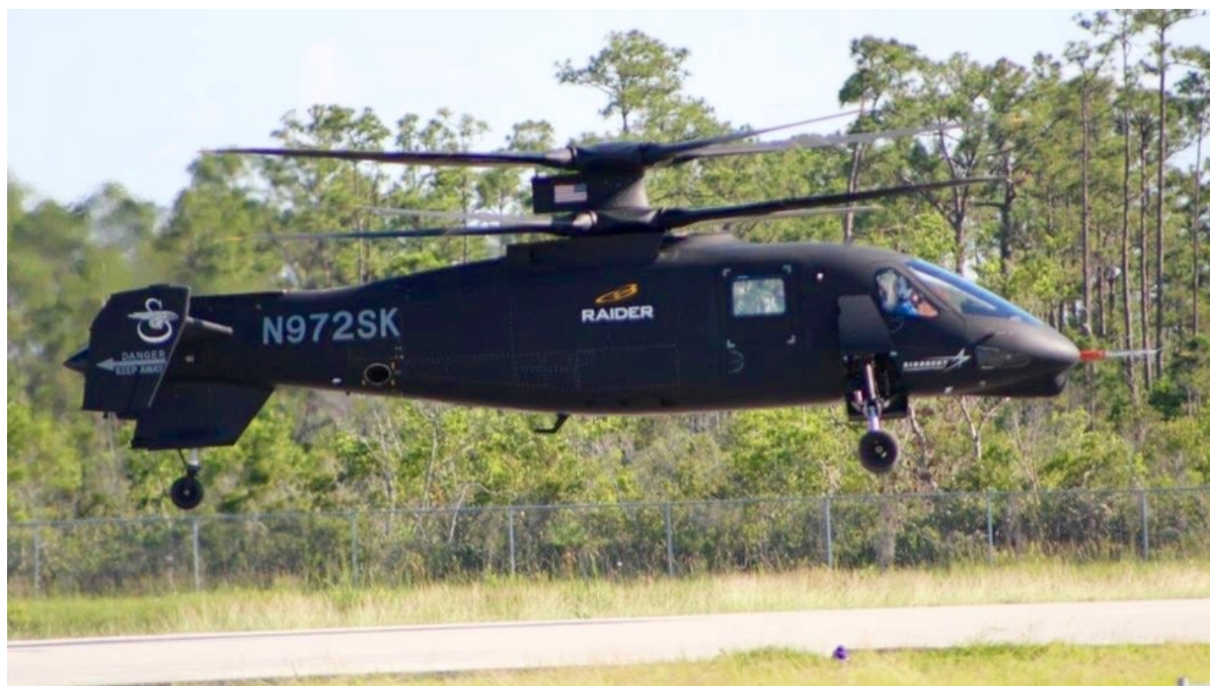
Prototyp śmigłowca S-97 Raider firmy Sikorsky, którego układ konstrukcyjny ma cechy podobne do konstrukcji AH-56A. Fot. Sikorsky
