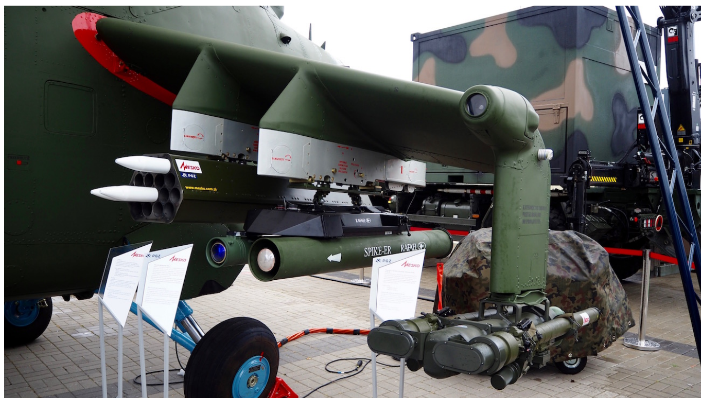
Propozycja uzbrojenia zmodernizowanych Mi-24 przez PGZ. W środku: pociski Spike ER i LR, z lewej strony: wyrzutnia rakiet 70 mm produkcji Mesko, z prawej: wyrzutnia z pociskami Piorun w wersji powietrze-powietrze. Fot. J.Sabak
