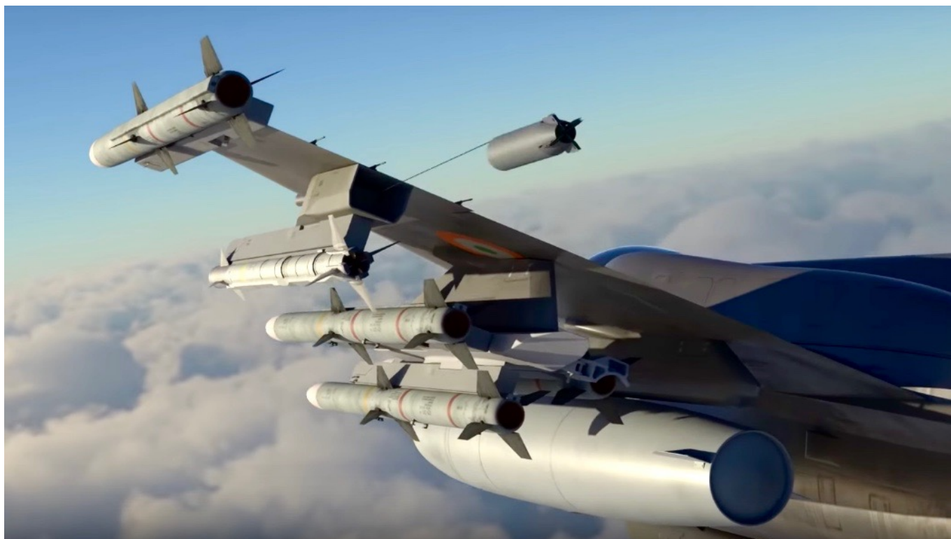
Wabik holowany ALE-50 wysuwający się ze specjalnego zasobnika w lewym pylonie podskrzydłowym. Fot. Lockheed Martin
