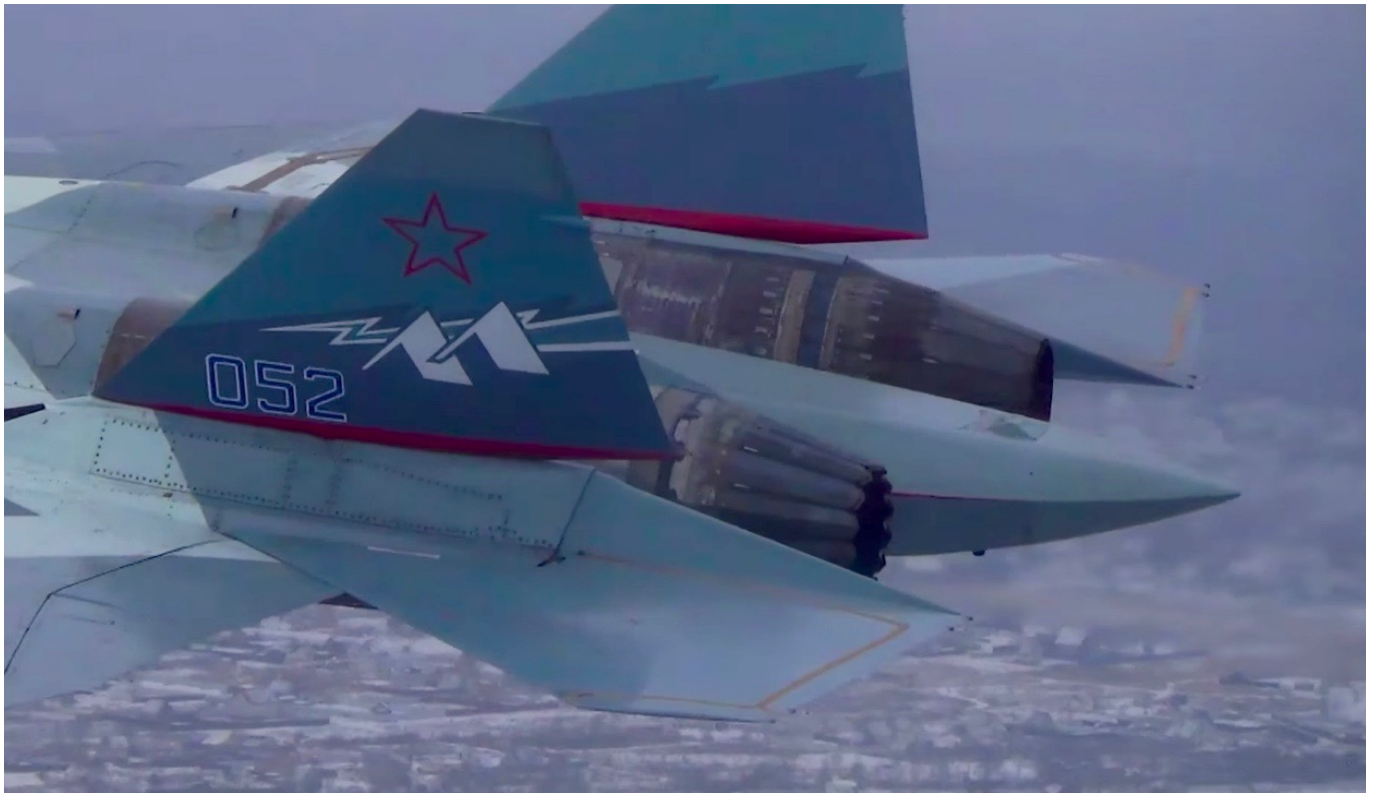
Prototyp Su-57 z nowym silnikiem "Produkt 30" (po lewej stronie) i starym AL-41 z myśliwca Su-35 po prawej. Fot. mil.ru
