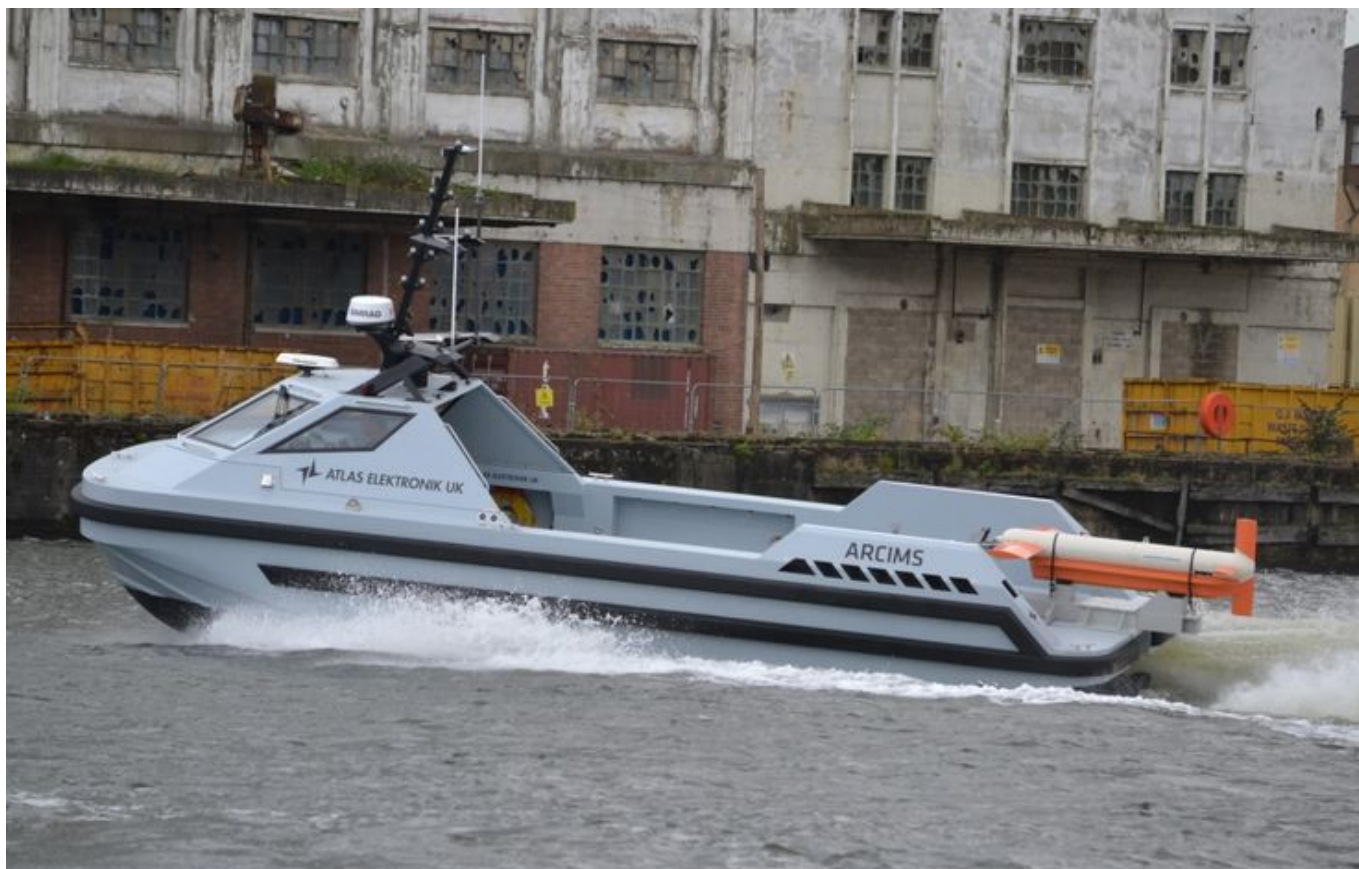
ARCIMS podczas prezentacji z modułem przeznaczonym dla sonaru SAS typu AQS-24B – fot. M.Dura
