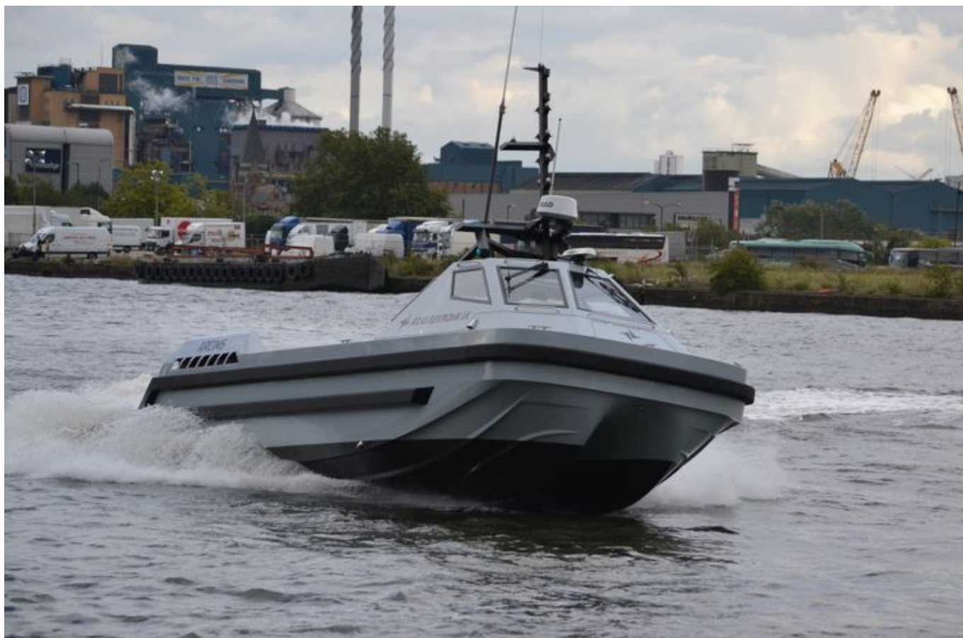
ARCIMS został zbudowany na bazie kompozytowej, dwukadłubowej łodzi motorowej – fot. M.Dura
