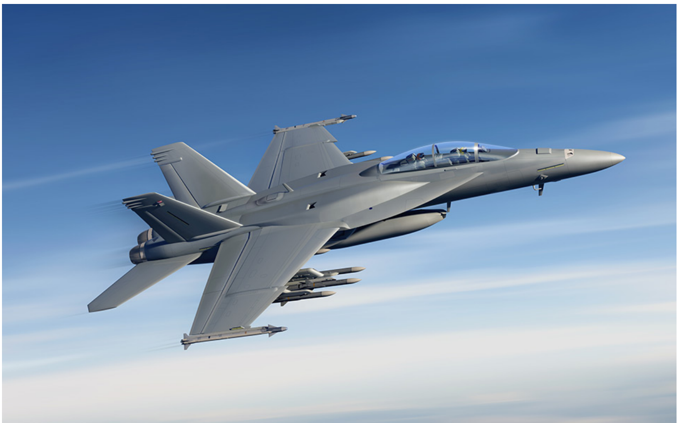
Konforemne zbiorniki paliwa na grzbiecie samolotu F/A-18 Super Hornet. Fot. Boeing
